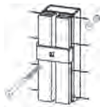
Pfosten-Anschluss in laufender Strecke
