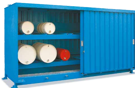
Liegende Fass-Lagerung Dadurch können Abfüllvorgänge innerhalb des Containers erfolgen. Abstellfläche aus feuerverzinkten Gitterrosten vor den Fässern. Für die aktive Lagerung brennbarer Stoffe ist eine Ex-geschützte technische Zwangsentlüftung erforderlich. Bitte anfragen.
