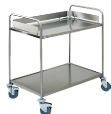
3 Abräumwagen • Mit dreiseitiger Schürze, 90 mm hoch • Traglast pro Boden 40 kg
