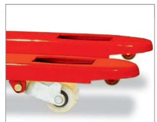
Kletterrollen in den Gabelspitzen für bequeme Einfahrt in quer aufzunehmende Paletten
